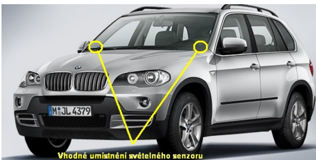
Obrázek 2. Způsob instalace světelného senzoru
