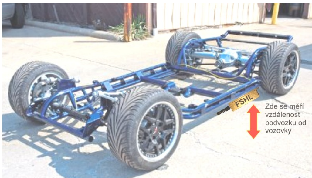
Obrázek 1. Možný způsob instalace pod zadní levý práh
