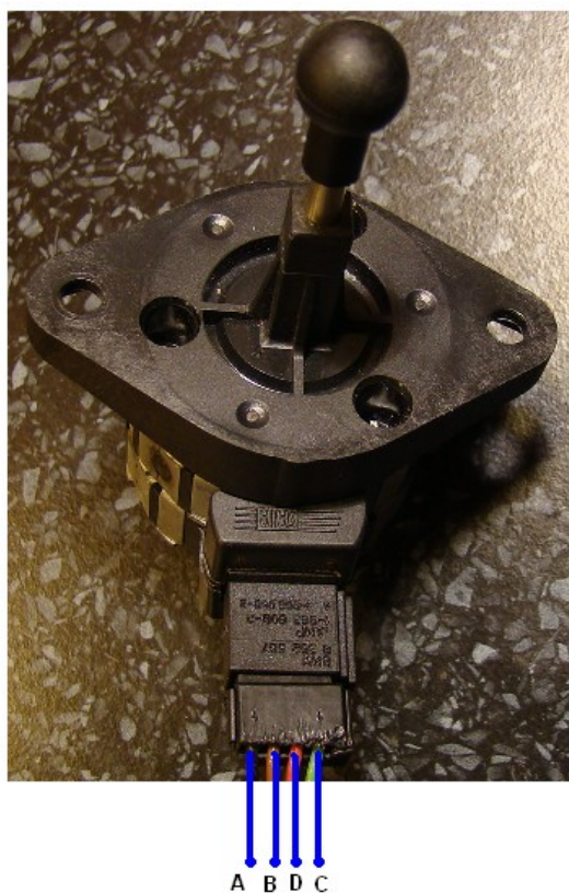
Obrázek 4. Zapojení 4 drátkového krokového motoru
