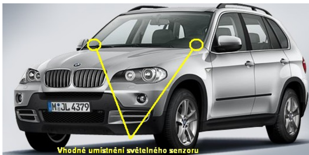
Obrázek 1. Způsob instalace světelného senzoru
